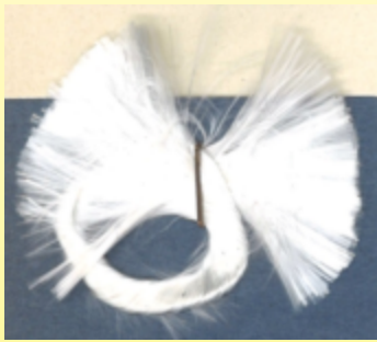
Haces de filamentos de vidrio formando un solo cable (Fabricación de filamento de vidrio, alrededor de 1960, lección de la escuela textil de Verviers en Bélgica, Museo Ultimheat)
