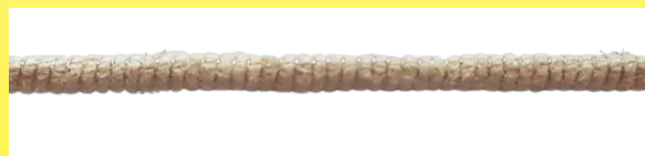
Circa 1960. Cuerda calefactora Calor, diámetro 1,7 mm, único cable de calefacción de níquel cromo, diámetro 0,08 mm, sobre un núcleo de algodón ligeramente torcido para evitar el torcimiento (Colección Ultimheat)
