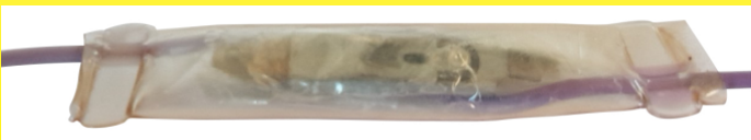
Limitador de temperatura de rotura lenta, utilizado junto con un sistema de control de energía inglés fabricado por GEC (General Electric Company). Está cubierto con una funda impermeable de PVC, soldada a los cables. Alrededor de 1970 (Colección Ultimheat)
