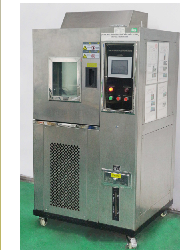
Cámara climática, con rango de ajuste de temperatura de -90 a +150\text{ }^{\circ}C , rango de ajuste de humedad relativa de 1 a 100 %
