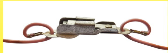
Limitador de temperatura de manta térmica de rotura lenta Calor, calibrado a 80 °C (circa 1960). Nótese la funda impermeable de PVC soldada en los cables y el bucle hecho por los conductores eléctricos que pasan por un agujero en cada terminal, esto es para eliminar tensiones de tracción en el cable (Colección Ultimheat)
