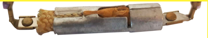
Limitador de temperatura de rotura lenta, utilizado junto con un sistema de control de energía inglés fabricado por GEC (General Electric Company). Está cubierto con una funda impermeable de PVC, soldada a los cables. Alrededor de 1970 (Colección Ultimheat)
