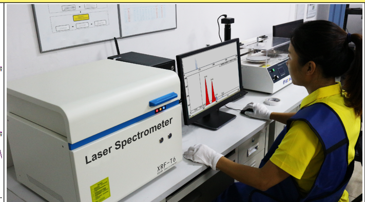
Análisis espectrométrico en progreso (Laboratorio Ultimheat)
