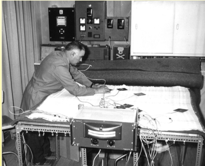
Medición de la temperatura superficial de la manta térmica (circa 1960, Vedette, Museo Ultimheat)
